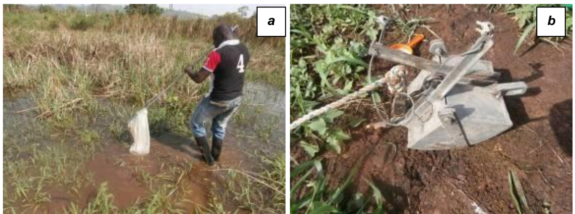
Figure 2.3: (a) Séance de collecte de macroinvertébrés à l'aide du filet troubleau; (b) Benne à sédiment modèle Van Veen (Photo : KONAN K. Félix ; avril 2015)
