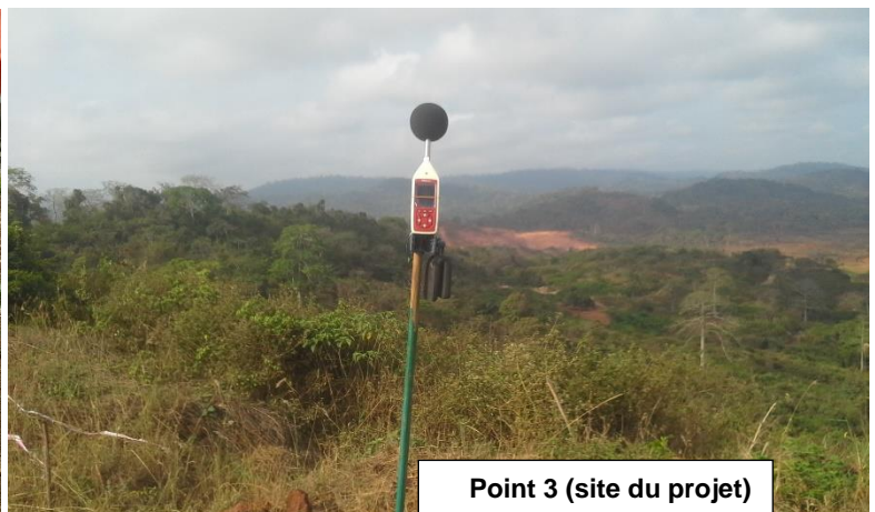
Photo 2-2 : Positionnement des sonomètres pour la mesure du niveau sonore
