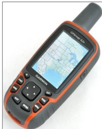
Photo 2-1 : GPSmap 62s de marque GARMIN utilisé pour la localisation des points de mesure
