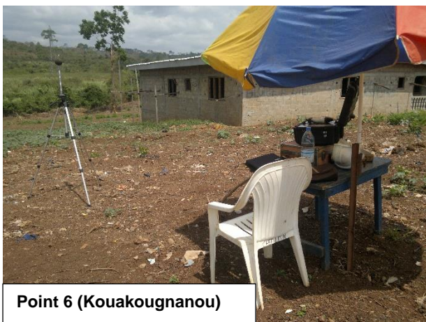
Photo 2-2 : Positionnement des sonomètres pour la mesure du niveau sonore
