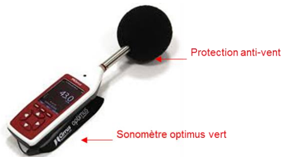
Photo 2-4 : Sonomètre optimus vert
