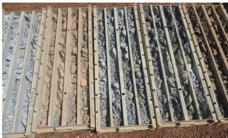
Photo 2.6 : Zone de fracture (aquifère) de 127m à 153m sondage SD293
